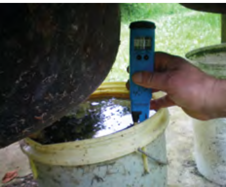
Mesure de la quantité de minéraux disponibles à l'aide d'un conductimètre dans le jus de lombricompost (à gauche), dans le lombricompost (à droite).
