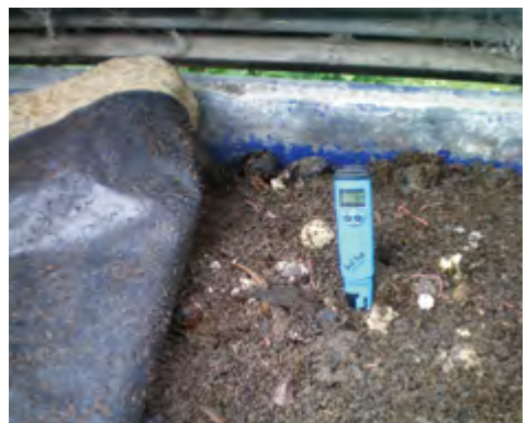
Mesure de la quantité de minéraux disponibles à l'aide d'un conductimètre dans le jus de lombricompost (à gauche), dans le lombricompost (à droite).
